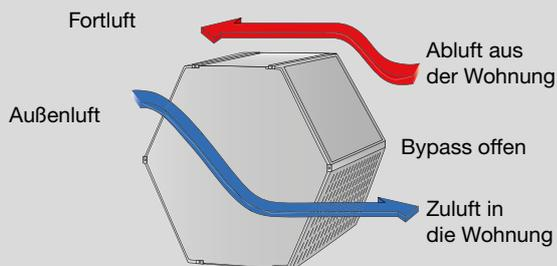
Komfortables Wohnraumklima dank Umgehung der Wärmerückgewinnung mittels 100%-Bypass
