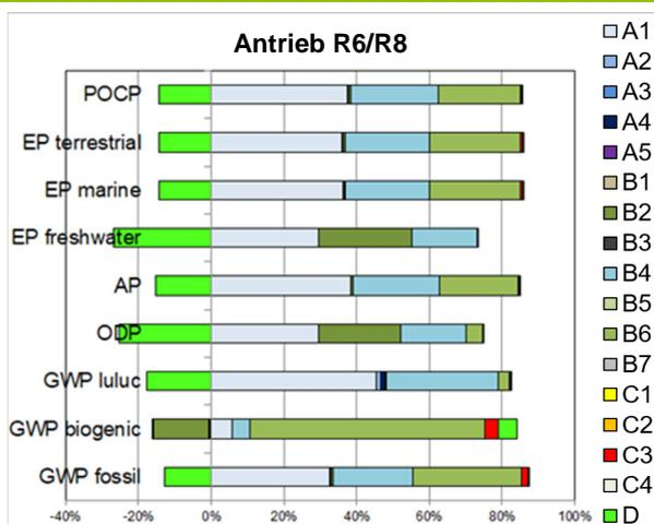
Abbildung 4: Prozentuale Anteile der Module an ausgewählten Umweltwirkungsindikatoren
