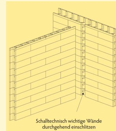
Schalltechnisch wichtige Wände durchgehend einschlitzen
