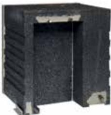
Raffstorekasten mit 12 cm Revisionsöffnung, die Schachthöhe von 22 cm kann eine gesamte Verschattungshöhe von 230 cm in sich aufnehmen (60 mm Flachlamelle).
