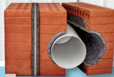
Unsere AIR ISO Elemente haben eine Höhe von 30,0 cm, die Breite beträgt 25,0 cm. Der Mauerstein kann einfach, durch unser AIR ISO Element ersetzt werden. Ziegelschale mit integriertem Dämmteil, Schallentkopplung des Lüftungsrohres durch das ganze Segment.
