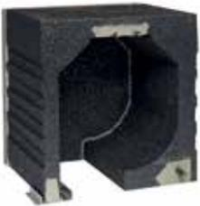
Rollladenkasten für 37 mm Stabhöhen, Behanghöhen von bis zu 350 cm möglich bei Verwendung von 40 SW-Stahlwelle (Rollraum 19 cm Durchmesser).
