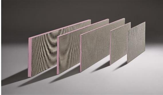
Beschichtetes Trägerelement als Untergrund für die Fliesenverlegung. Austrotherm XPS® TOP-Dämmplatte, beidseitig mit kunststoffvergütetem Mörtel beschichtet und mit Textilglasgitter armiert.
